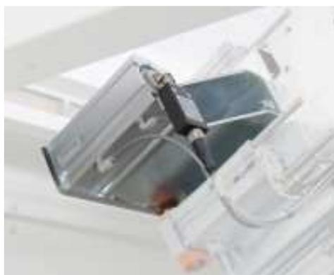
Упор для заготовок расположен на сверлильной голове. При программировании начального положения сверлильной головы возможно расположить нулевой упор в нужном положении, чтобы избежать возможного соударения с пилами или радиусным закруглением.
