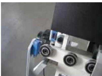
Устройство считывает размеры заготовки по оси X и автоматически компенсирует погрешности этих размеров. Это позволяет добиться высокой точности при стыковке щитовых деталей мебели, когда имеются расхождения в размерах этих деталей.
