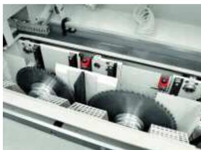
**41.12.50 Электронная регулировка подрезной пилы** N. 1
