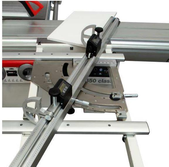
**57.01.57 Электронно- управляемая параллельная линейка**
