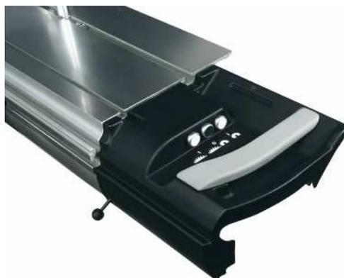
**58.05.04** Линейка с 2-мя ЖК датчиками (индикаторами) положения перекидных упоров, каждый упор снабжен системой считывания по магнитной ленте и отображением размеров на индикаторе с ЖК-дисплеем
