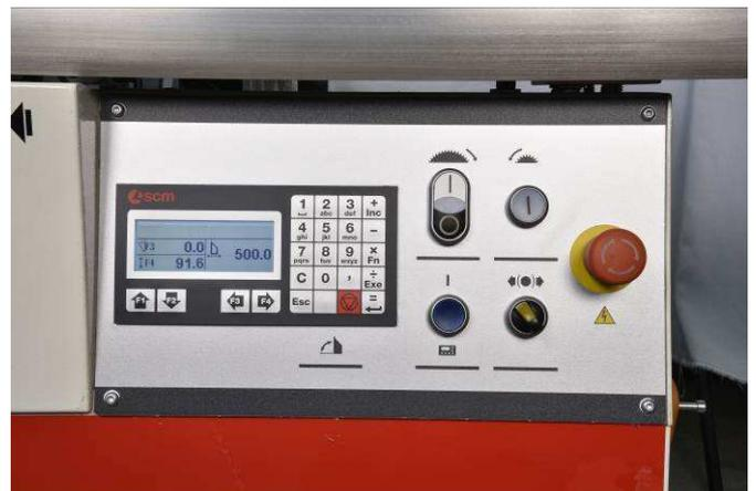
Электронный дисплей для отображения положения параллельной линейки
