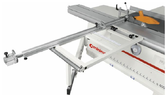
Регулировка подрезной и основной пилы сбоку станка. Удобно и наглядно.
