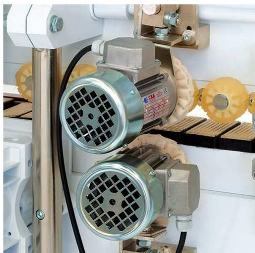
Предназначен для удаления возможных остатков клея, восстановления цвета PVC / ABS кромок и полировки после фрезерной обработки и цикли.
