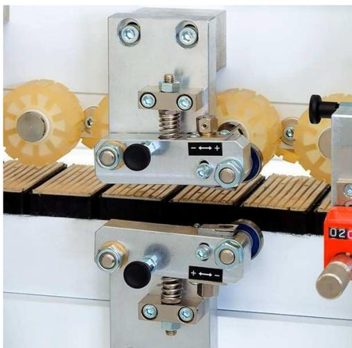
Цикля предназначена для удаления возможных остатков клея на верхней и нижней поверхности панели.
