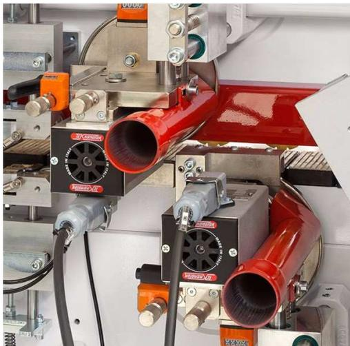
Две автономные станции (верхняя и нижняя) для снятия свесов продольно по верхней и нижней пласти плиты. Горизонтальные и вертикальные копиры с цифровыми индикаторами SIKO для легкой и точной регулировки;
