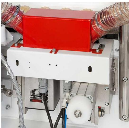
Два ВЧ- двигателя, первый 1,5 кВт вращается по часовой стрелке, второй 0,75 кВт, вращается против часовой стрелки, с пневматическим управлением давления на обоих двигателях, обеспечивающих оптимальную обработку.
