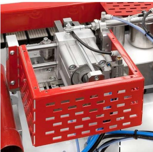
Точная обрезка свесов кромочного материала на передней и задней стороне панели с помощью пневматической гильотины.
