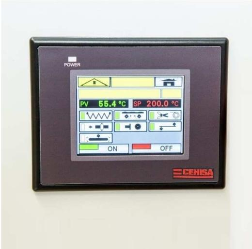
Компактная панель OMRON NB 3,5" с интегрированным дисплеем и кнопками контроля основных функций станка;
